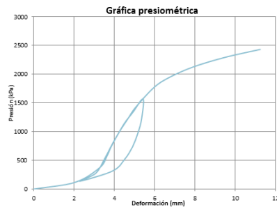
Figura 2. Representación gráfica de un ensayo presiométrico con un ciclo de descarga y recarga.
