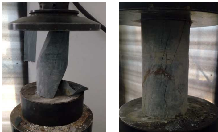
Figura 6. Probetas de UG3 tras rotura en ensayo de compresión uniaxial.
